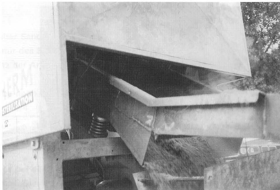
**Bild 4:** Beflammung des Sandes innerhalb der REATTHERM-Anlage
